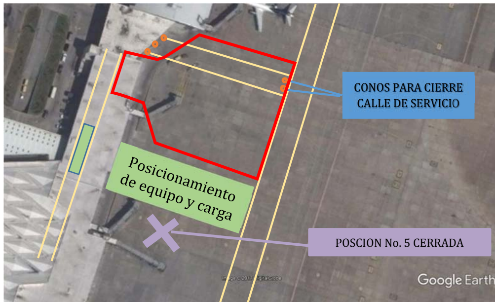
FIGURA 1: Medidas de seguridad adicionales al operar en Posición No. 6
